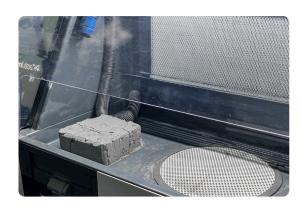
4. Teile entnehmen: Dieser Schritt wird mit Sicherheit Kindheitserinnerungen an den Sandkasten hervorrufen! Ein mitgelieferter Satz Bürsten und Pickel in verschiedenen Größen hilft beim Schaben und Entfernen von Pulver selbst aus den kleinsten Details. Pulverstücke können leicht von Hand zerkleinert oder mit der mitgelieferten großen Bürste abgeschrubbt werden. Ein Drahtkorb steht Ihnen zur Verfügung, in dem Sie Ihre Teile ordentlich sammeln können, während Sie den Druck weiter bearbeiten.
