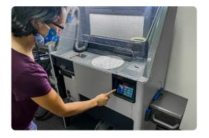
2. Siebprozess starten: Wenn Teile aus dem Presskörper entnommen werden, wird ungesintertes Pulver gelöst und in das Sieb unter dem Arbeitsbereich geleitet. Ein Sieb filtert kleine Brocken oder Ablagerungen heraus, um das Pulver sauber zu halten. Das wiederverwertete Pulver wird dann in einem speziellen Einfülltrichter gelagert, bis es mit frischem Pulver für den nächsten Druck gemischt wird.
