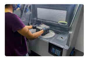
3. Presskörper entnehmen: Verwenden Sie die greifbaren und virtuellen Steuerungselemente zum Anheben und Absenken des Druckbetts, sodass der Presskörper aus der Konstruktionskammer in den Arbeitsbereich des Fuse Sift befördert wird. Dies hilft bei Drucken, die ein dicht gepacktes Sortiment von kleinen oder verschiedenen Teilen enthalten.
