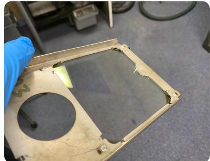
**Nach der Reinigung:** Dieselbe optische Kassette nach der Reinigung mit Alconox, destilliertem Wasser und Ethanol zur Entfernung der Ablagerungen
