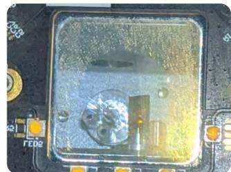
9. Verwenden Sie den mitgelieferten Teleskopspiegel, um das obere Laserfenster zu finden. Das obere Laserfenster befindet sich in der Gehäusedecke und liegt normal hinter der größeren Scheibe der optischen Kassette.
